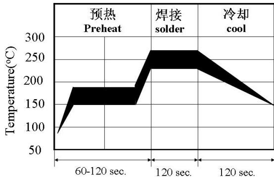
注意：如果回流焊温度超过图表建议最高温度（260°C），元件可能损坏而达不到规范要求。
